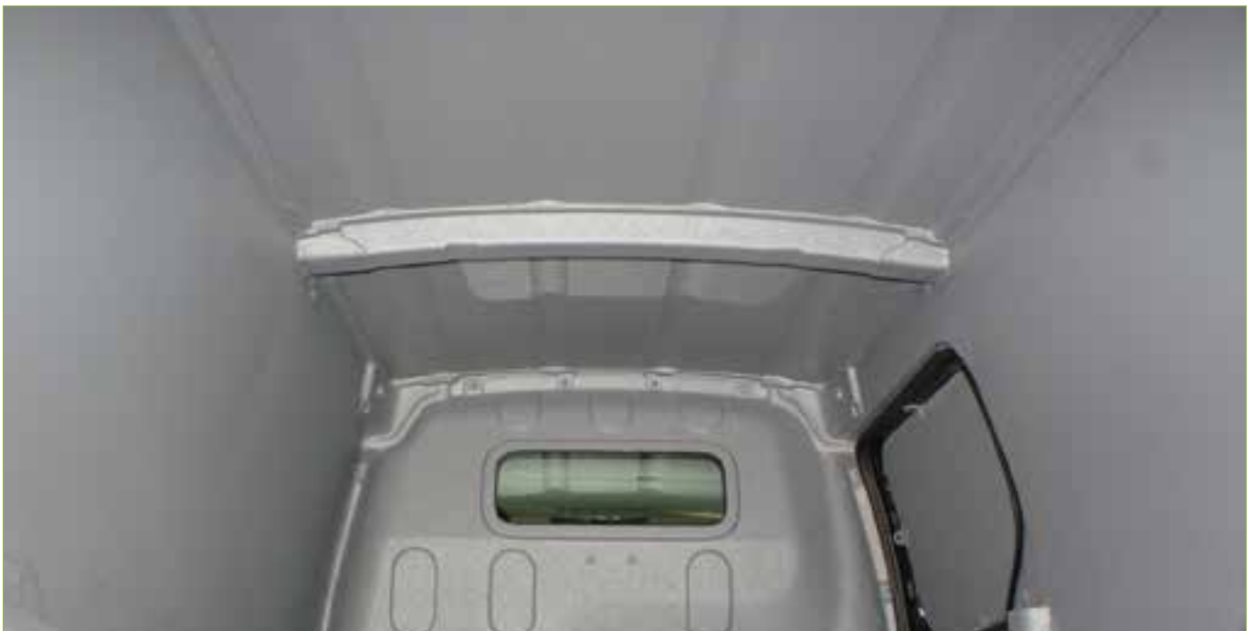
Bij de volledige behandeling wordt zelfs het plafond duurzaam beschermt met Turbo Liner®.
