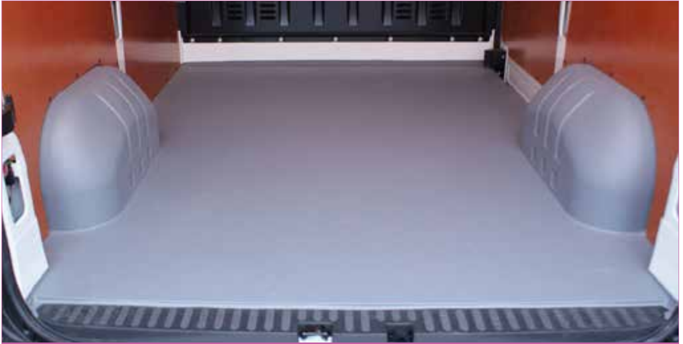
Bij een behandeling 'Laag dicht' maken we een naadloze vloer en betimmeren we de wanden.
