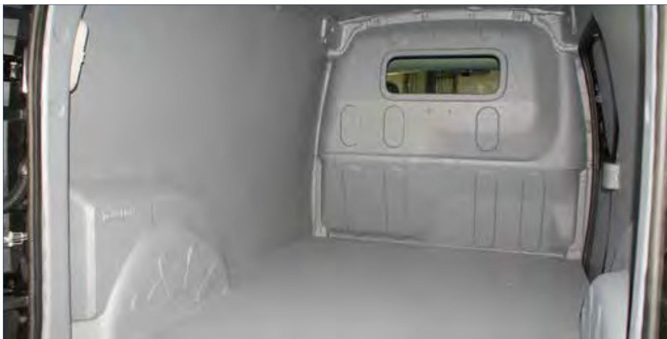
Turbo Liner® is altijd inclusief een betimmering van een vloer en wanden voor een strak geheel.
