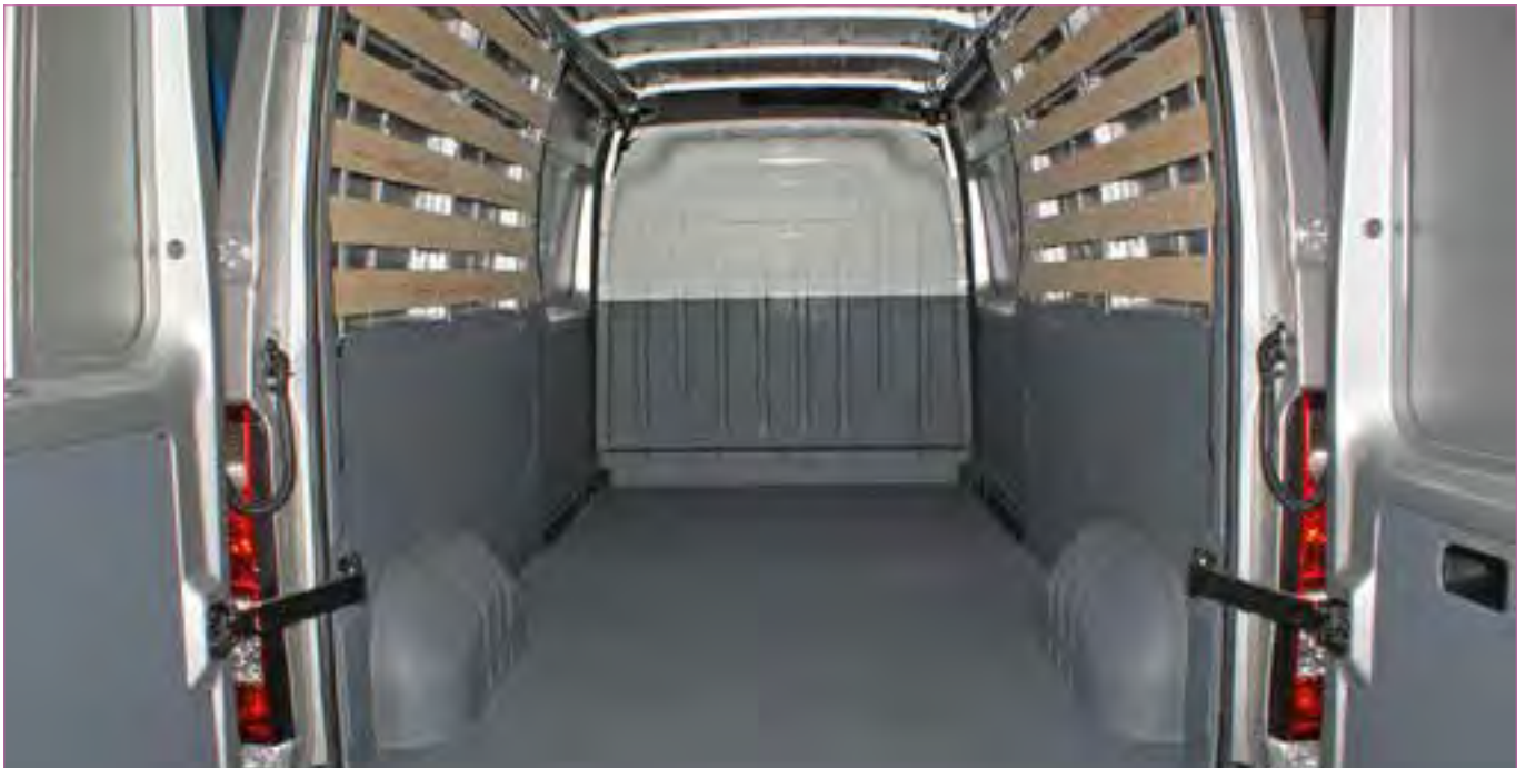
Bij een half hoge behandeling creëren we, met uitzondering van schuifdeur, een naadloze kuip.
